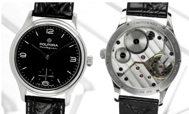
POLPORA Fortepian: kaliber ETA 6498-1 zdobiony szlifem genewskim, naciąg manualny, 17 kamieni, stal nierdzewna 316LS, szkła szafrowe, niklowane wskazówki, 5 ATM, wielokrotnie sygnowany, skórzany pasek
